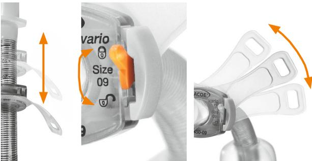
A cânula TRACOE vario possui uma flange ajustável. Por meio de um prático mecanismo de duplo travamento, a flange pode ser movida ao longo da cânula de traqueostomia e ajustada de acordo com as necessidades de cada paciente. A flange é fixada firmemente movendo a alavanca laranja para cima. Nenhum travamento por parafuso é utilizado.
